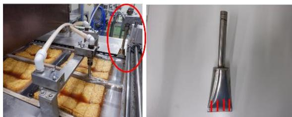
VD9号 シャトルコンベアでの投入時に揚げが乱れるため落下位置の板にバネを入れ落下する高さを小さくしバネで衝撃を減らす
